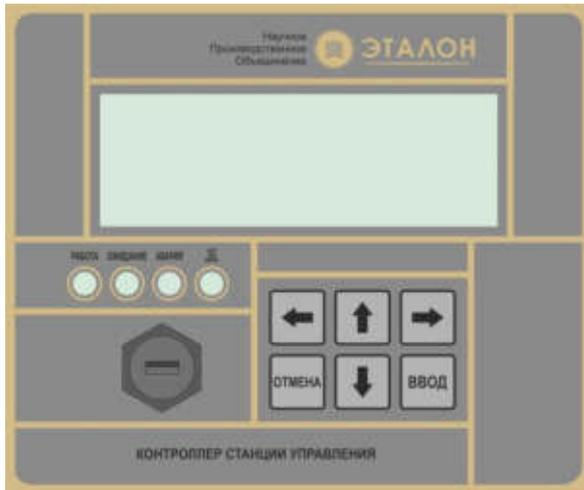
Рисунок 1а - Панель оператора-03.
