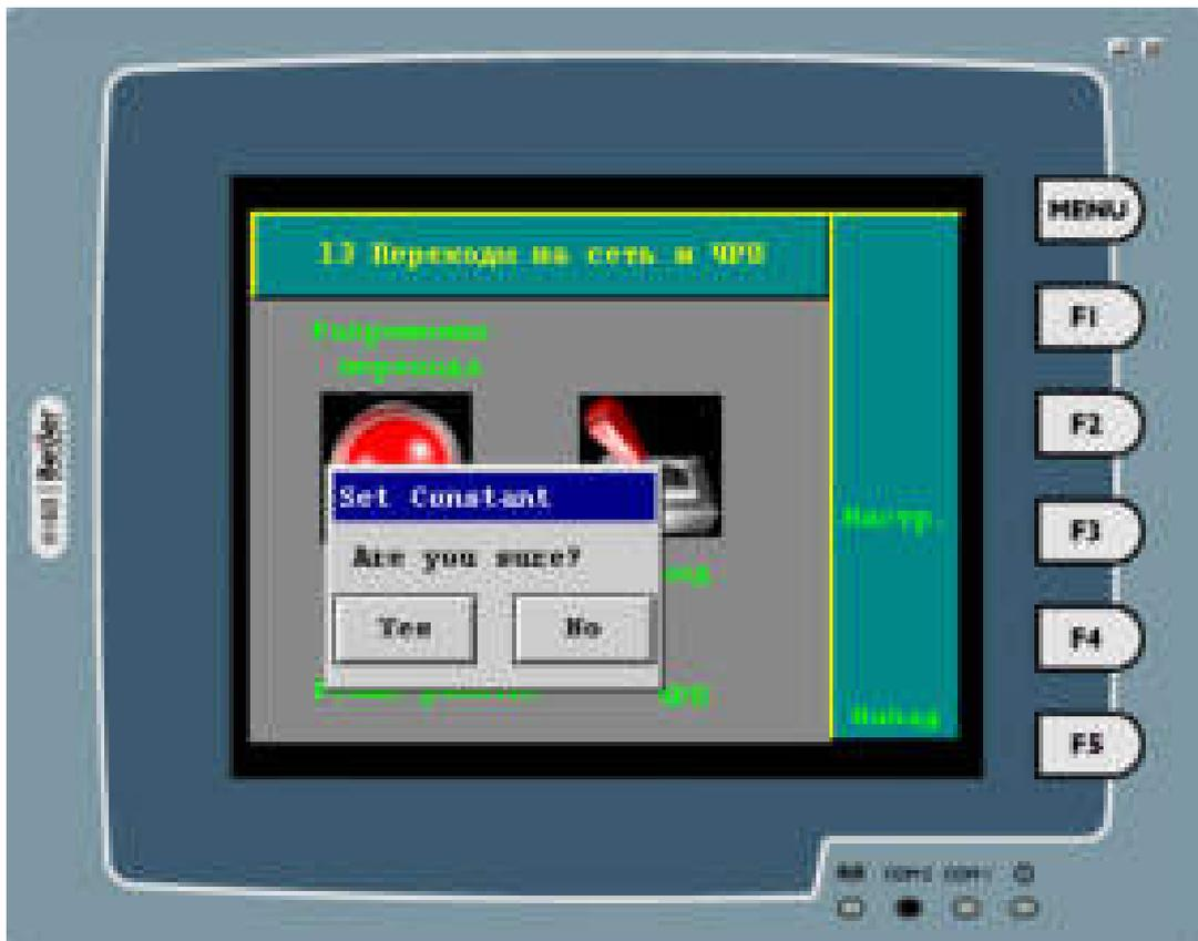
Рис. 17. Графическая панель оператора, окно запроса подтверждения перехода
