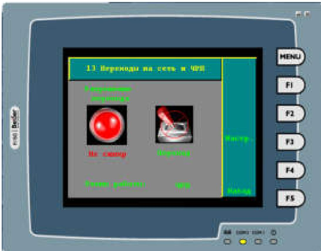
Рис. 16. Графическая панель оператора, окно переходов на сеть с ЧРП и обратно, с сети на ЧРП.
