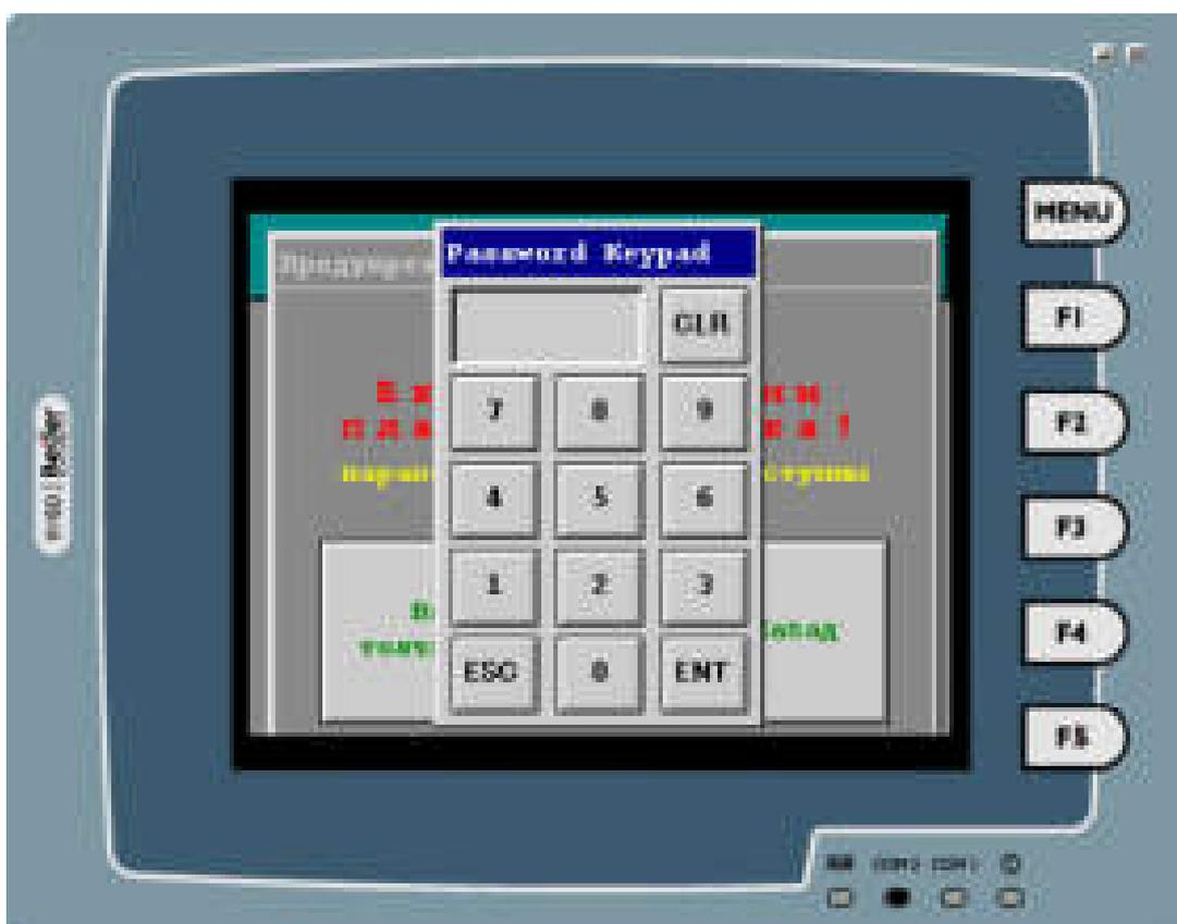
*Рис.9. Графическая панель оператора, окно запроса пароля при вводе изменении параметра*
