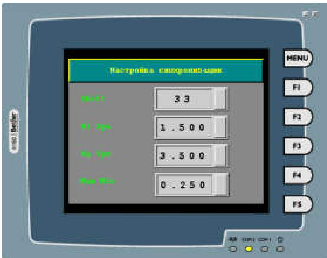
Рис. 18. Графическая панель оператора, окно настройки параметров регулятора синхронизации с сетью. Эти значения установлены по умолчанию. Доступ к изменению параметров возможен только по паролю разработчика.
