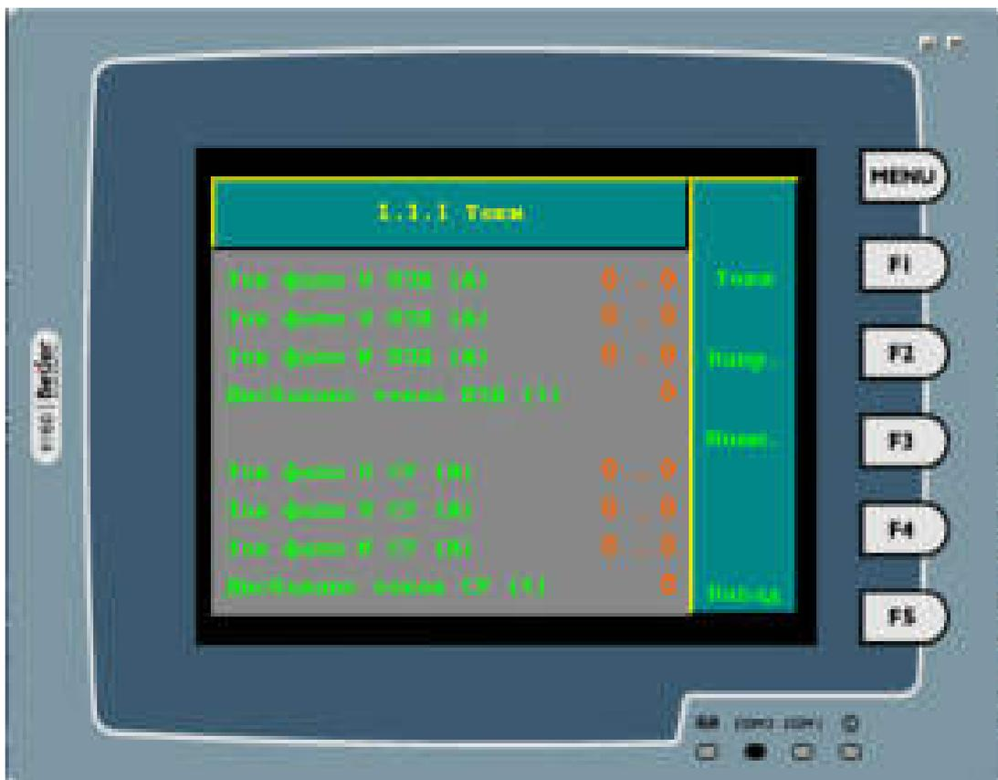
Рис. 4. Графическая панель оператора, окно измеряемых параметров
