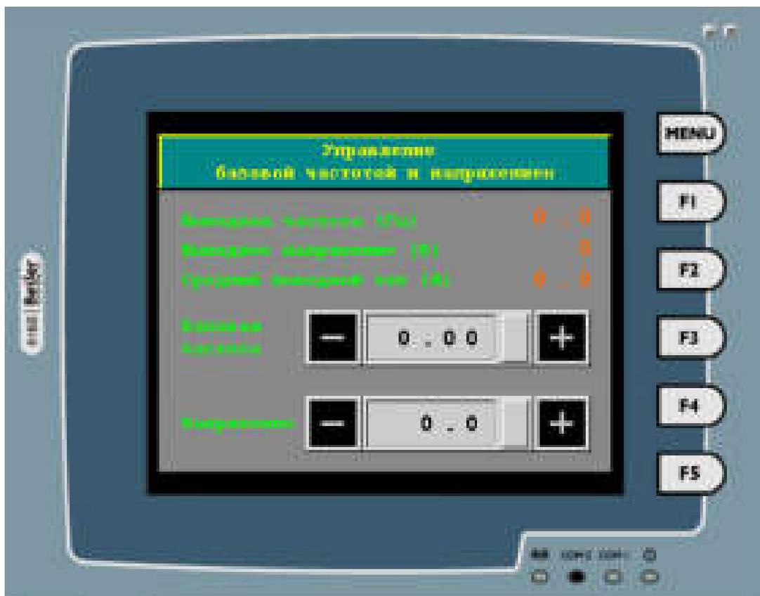
Рис. 12. Графическая панель оператора, окно настройки режима U/F
