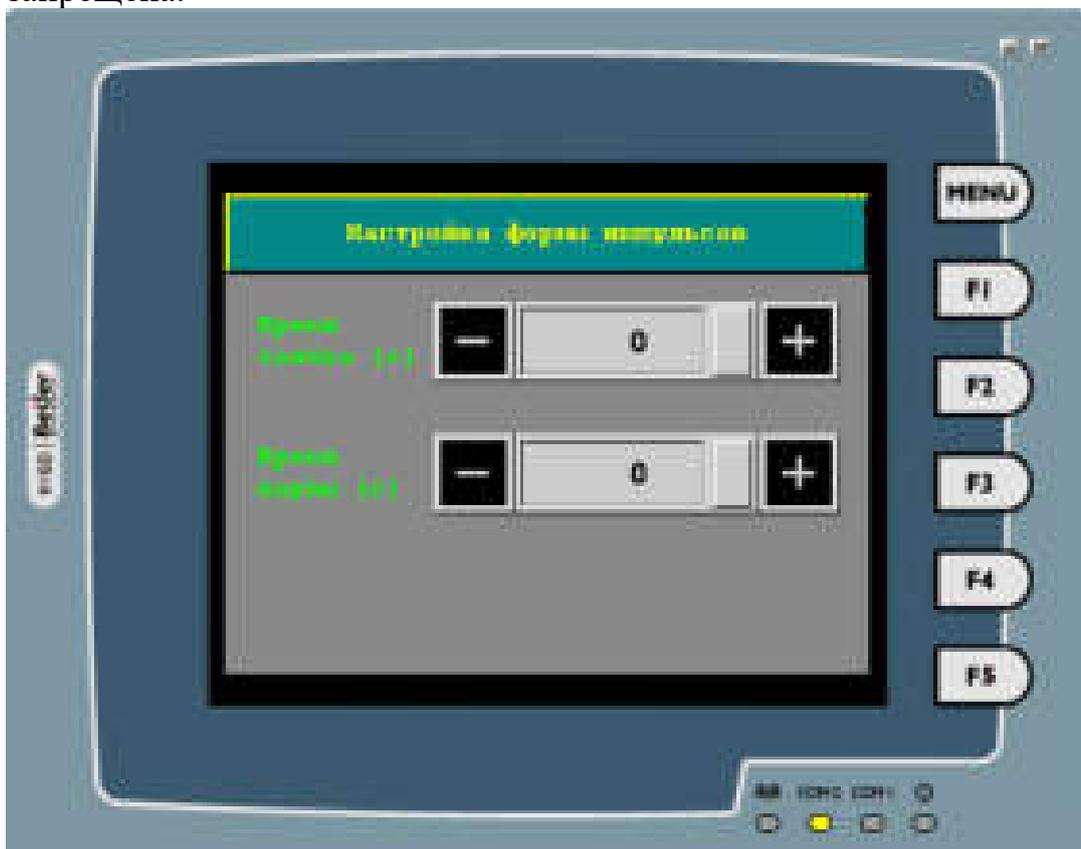
*Рис. 10. Графическая панель оператора, окно настройки формы импульсов*
