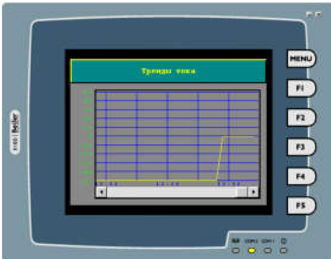
Рис. 13. Графическая панель оператора, окно трендов тока
