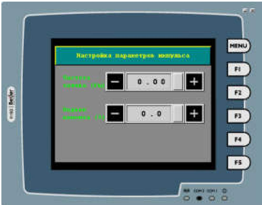
Рис. 8. Графическая панель оператора, окно настройки параметров импульсов
