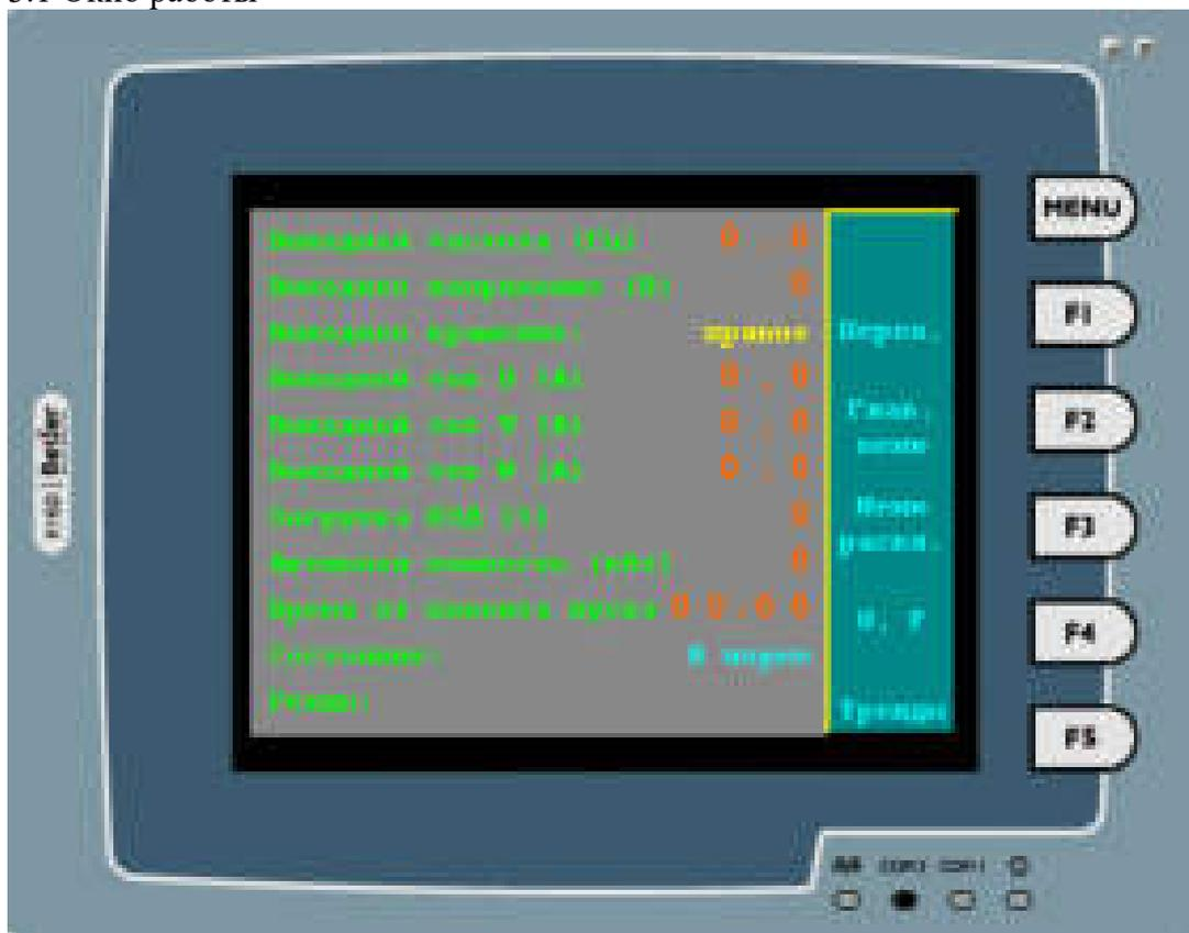
Рис.3. Графическая панель оператора, окно работы
